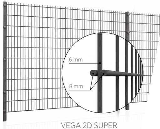
Matten ohne Verstärkungsfalten, verstärkt mit Doppeldraht mit größerem Durchmesser.
